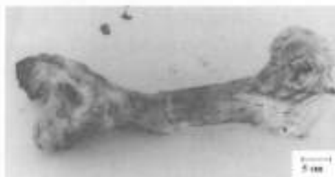
Şekil 7: Eğme deneyinde kırılmış bir dana femuru [11]
