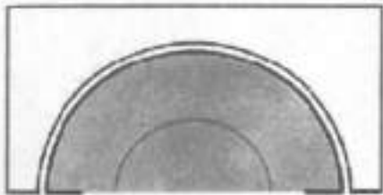
Şekil 5 : Çimentosuz asetabular komponentlerle pres-fit tespit. "Snap fastener" mekanizması ile yük altında asetabulumun kubbesinde düzleşme geliştiğinde bu tip implant ile kubbede temaslı yüzeyin devamı sağlanırken periferde asetabular komponent asetabulum kenarları tarafından sıkıştırılır. Böylece yüksek kompresyon kuvvetleri kubbe (dome) yerine periferde (zonl- 3) iletilir.
